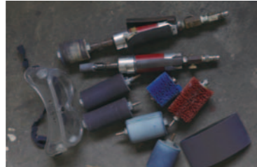
ヒゲやアタリ感を出す、グラインダーやブラシ。手に馴染んだこのツールで独特の製品を仕上げしていきます。
